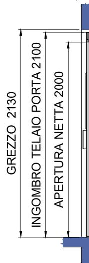
SEZIONE VANO CORSA
