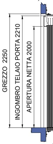
SEZIONE VANO CORSA
