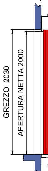
SEZIONE TELAIIO PORTE NF (EI120)
