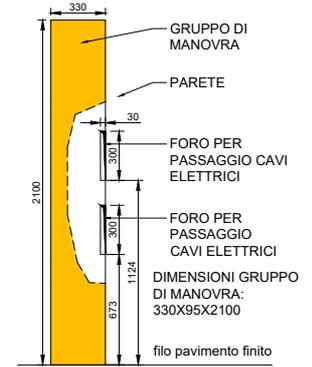
Viene fornito 0,8 m di cavo aggiuntivo per consentire il posizionamento del gruppo di manovra sul pianerottolo nel raggio di 0,8 m dalla posizione standard a cura del Cliente.
