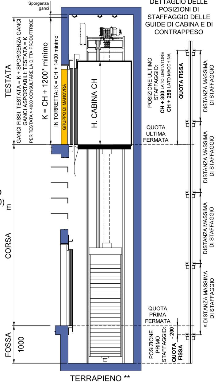
\* E' POSSIBILE AUMENTARE LE DIMENSIONI DEL VANO FINO AI VALORI MASSIMI INDICATI. PER VANI CON DIMENSIONI COMPRESSE TRA I VALORI MINIMI E MASSIMI, AUMENTARE TUTTE LE QUOTE INDICATE CON ♦ DELLA DIFFERENZA CON IL VALORE MINIMO. LA DIMENSIONE DELLA TESTATA È GARANTITA PER VANI CON DIMENSIONI COMPRESSE TRA I VALORI MINIMI E MASSIMI. PER VANI CON DIMENSIONI MAGGIORI CONTATTARE LA DITTA PRODUTTRICE.
