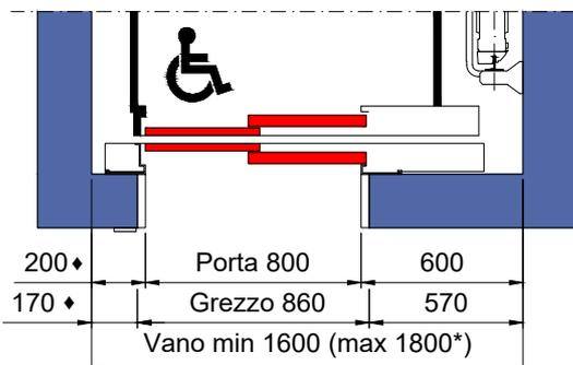
SEZIONE VANO CORSA
