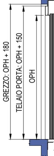
**SEZIONE VANO CORSA**
